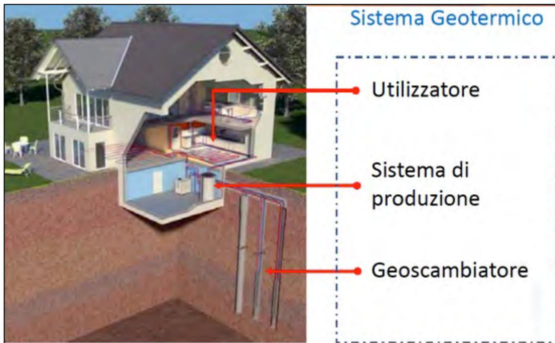
Figura 50: Sistema geotermico per climatizzazione edifici (Fonte: TREVI Group)
