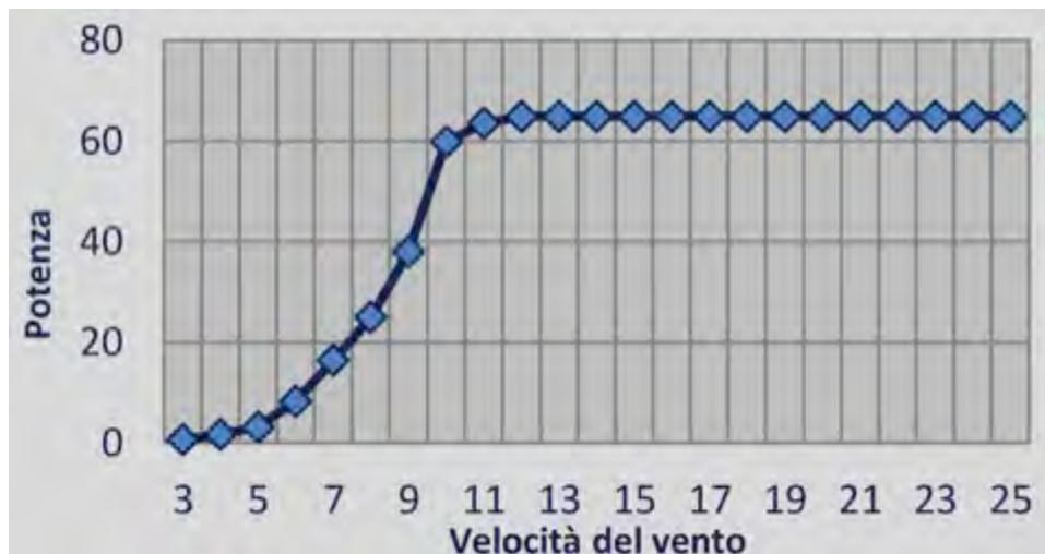
Curva di potenza aerogeneratore 60 kW.
